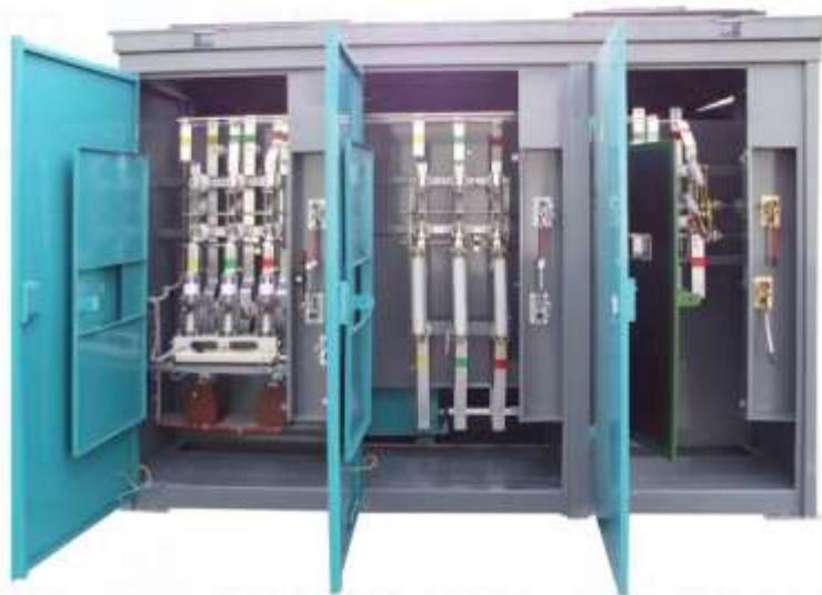
Подстанция обеспечивает учет активной энергии с помощью счетчика и соответствующих трансформаторов тока, имеет электрические и механические блокировки, обеспечивающие безопасную работу обслуживающего персонала. Для создания нормальных условий работы электроаппаратуры в КТП- 03 имеет обогрев.
